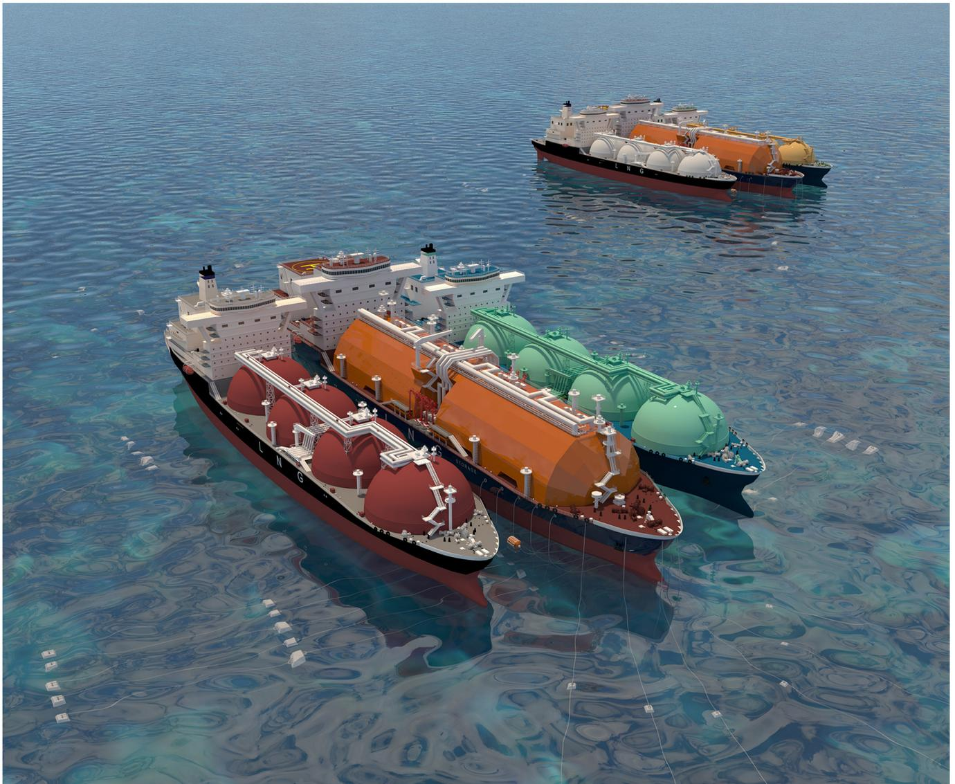
3D-Darstellung von zwei schwimmende LNG-Gasspeichern mit Ankerstopp und je zwei Tankschiffen – Quelle: shutterstock / LaNataly
