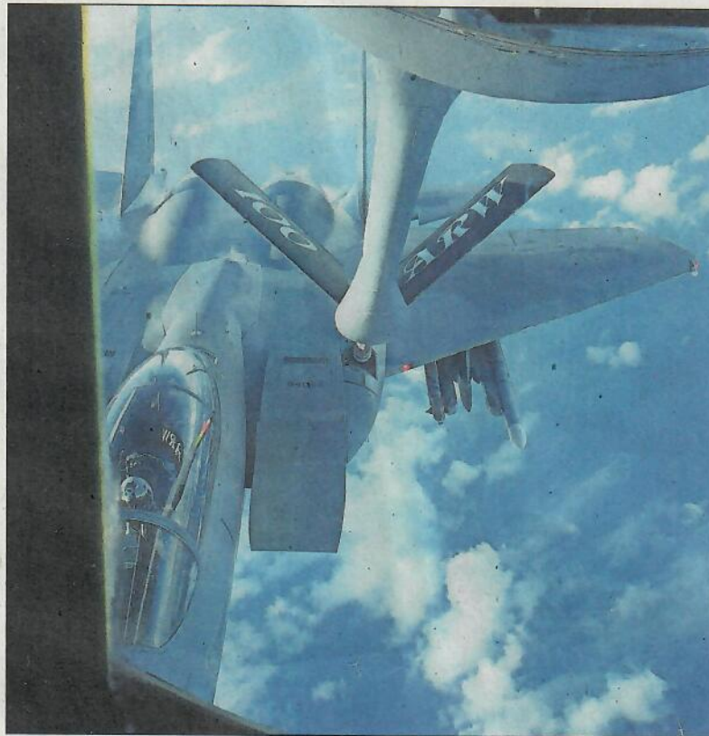
Die Tankflugzeuge vom Typ KC 135 versorgen unter anderem – wie auf diesem Bild – Flieger vom Typ F15E in der Luft mit Treibstoff.
